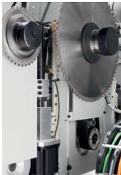
A subida da lâmina motorizada garante uma **regulagem precisa e rápida** da projeção da lâmina.
