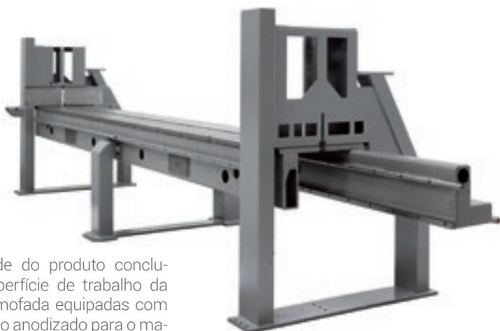
Máxima qualidade do produto concluído graças à superfície de trabalho da máquina com almofada equipadas com mesas de alumínio anodizado para o manuseamento de materiais delicados. Esta característica também permite manter a superfície constantemente limpa imediatamente ao lado da lâmina.
