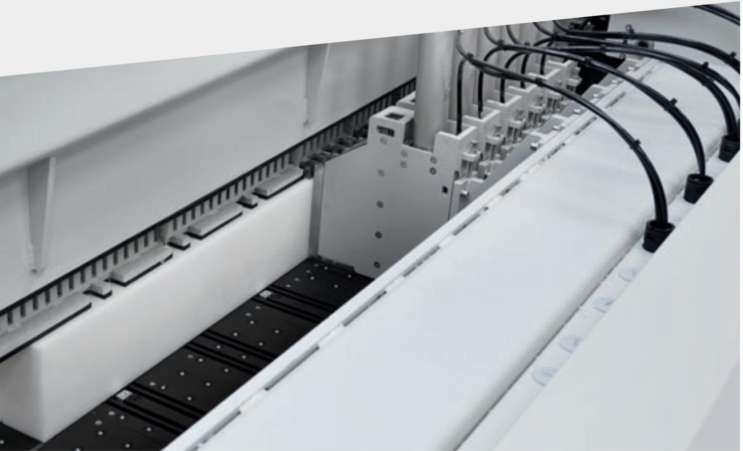
A prensa dupla possui uma estrutura duplicada e independente, que permite uma pressão homogênea e controlada sobre a pilha de painéis a serem cortados, graças à ausência de aberturas para a passagem das pinças, e cria uma verdadeira câmara hermética nos cortes de acabamento, permitindo uma aspiração eficaz do pó.
